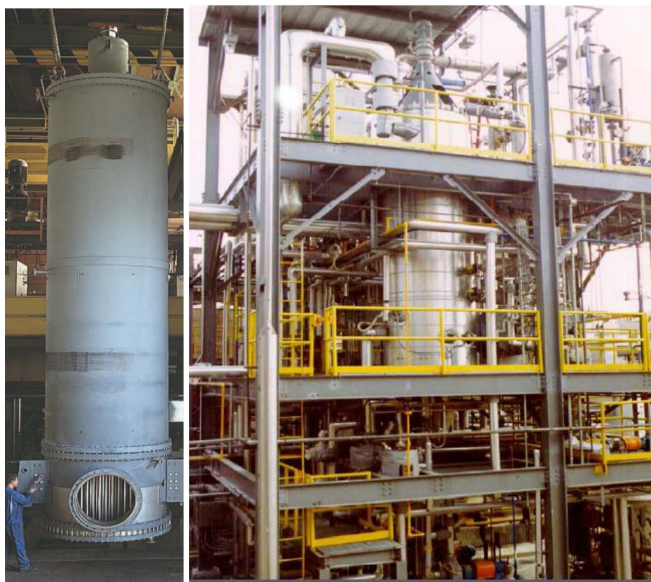
Figura II.13: Vista de columnas de destilación molecular de la fracción “Bajo Mono” para obtener la fracción “Alto Mono”, UIC GmbH company, Alemania.
