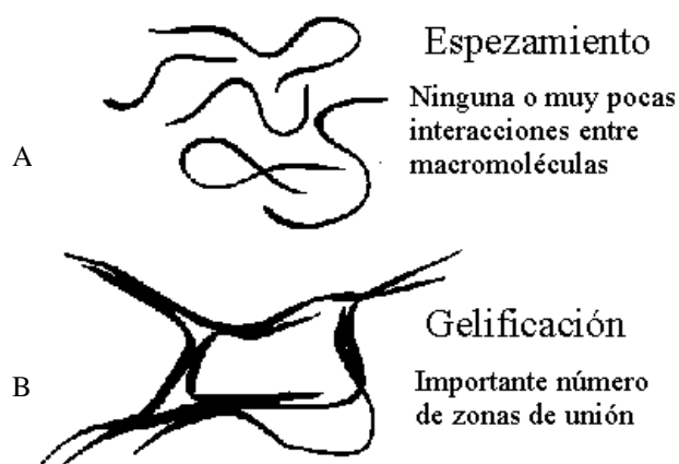
Figura 3.3: Mecanismo de gelificación de los hidrocoloides
