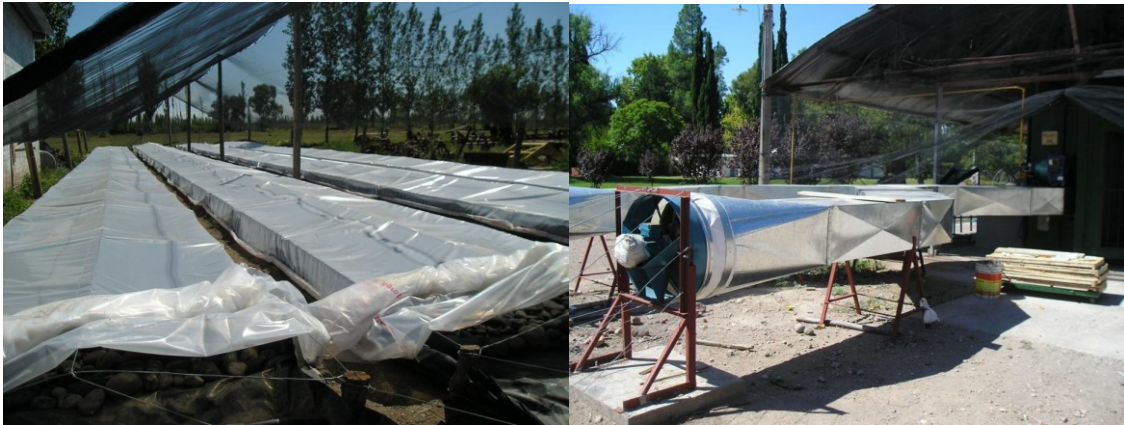
Figura 24: Aspecto que presentan los colectores solares (izquierda) y las turbinas de impulsión de aire (derecha) en un sistema de secadores activos mixtos solar-gas (Fuente: Horno piloto INTA EEA Rama Caída).
