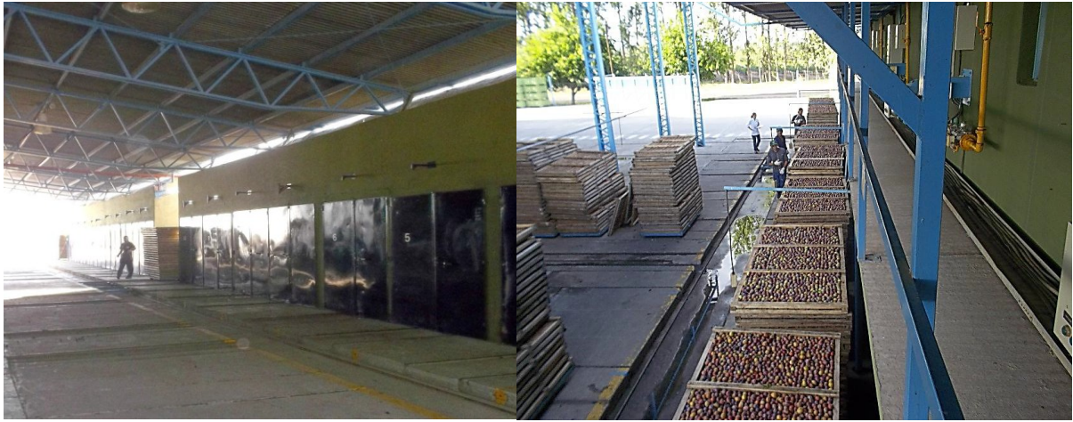
Figura 26. Perspectiva de un horno de gas de carros de alta producción (Fuente: Frutas Proa - Productos Andinos S.A. San Rafael, Mza.)
