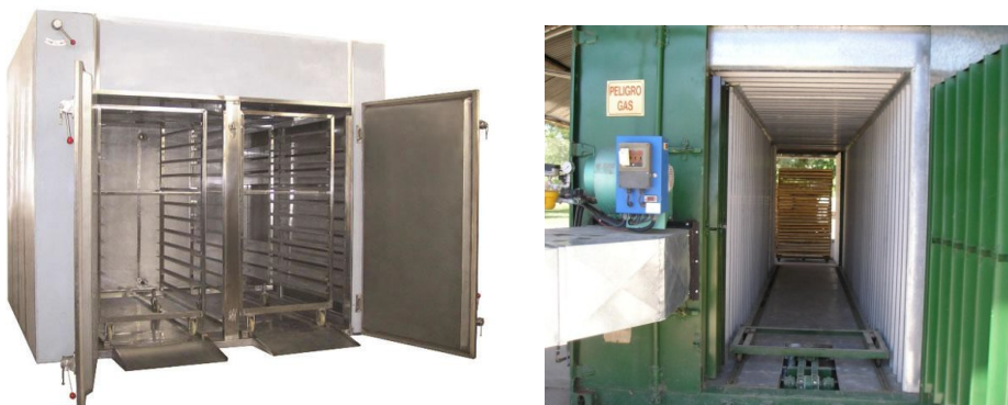
Figura 25: Aspecto que presenta un hornos de carros alimentado a gas de pequeña (izquierda) (Fuente: www.dryingmachineschina.es ) y mediana (derecha) escala de producción (Fuente: Horno piloto INTA EEA Rama Caída)
