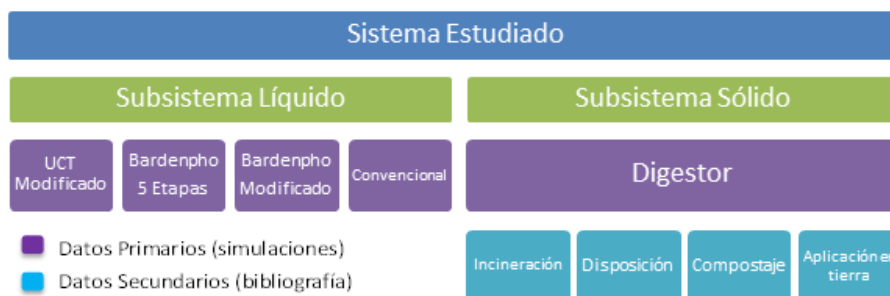
Figura 4.6.: Esquema cualitativo del sistema estudiado y fuente de los datos utilizados
