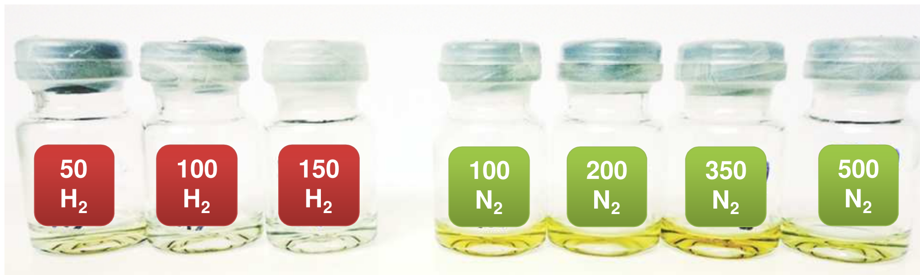
Figura VI.8: Condensados de la reacción en estudio (C6OL no convertido y productos de C3-C24) recolectados a la salida del reactor, para ensayos realizados a diferentes tiempos de contacto en atmósferas de N_2 e H_2 . [Catalizador: 8.0CuMgAl, T = 573 K, P = 101,3 kPa, \bar{P}_{C6OL} = 4,1 kPa]
