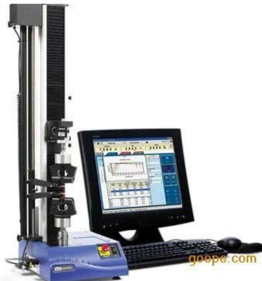
**Figura 2.8.** Equipo utilizado para la determinación de resistencia mecánica de papeles cerámicos.
