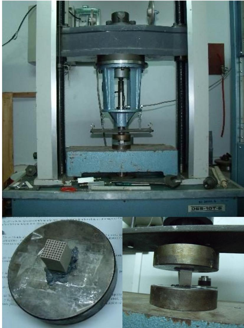
**Figura 2.11.** Equipo utilizado para el ensayo de compresión de monolitos tipo panal de abeja. Detalles de la colocación de las muestras en la celda de cargas.
