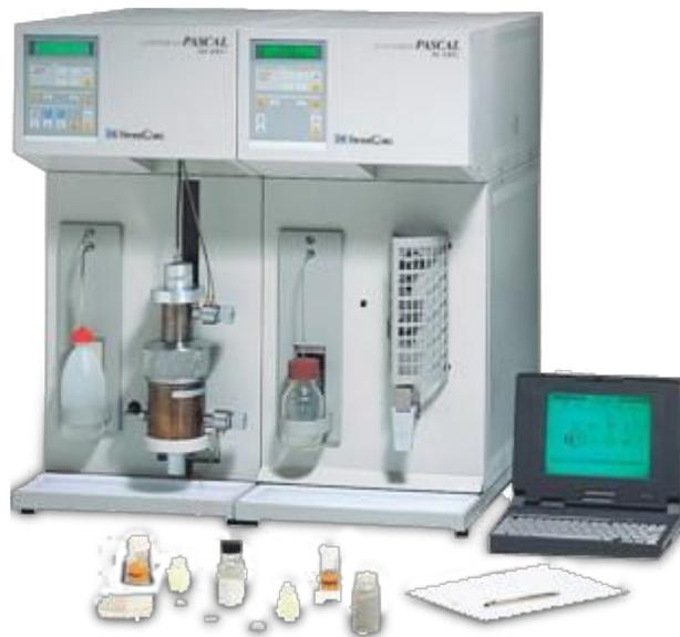
**Figura 2.14.** Equipo utilizado determinación de propiedades texturales de pellets, discos y monolitos tipo panal de abeja.
