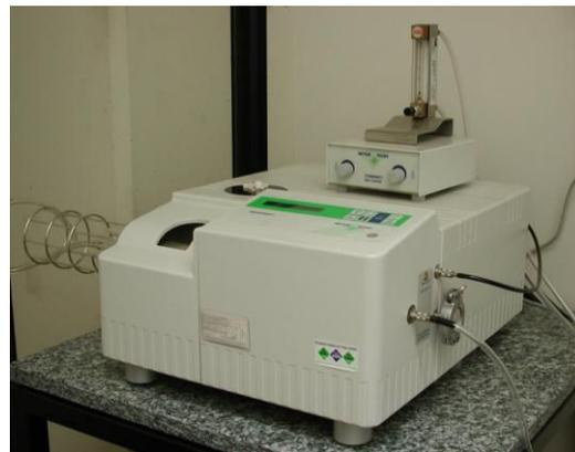
**Figura 2.4.** TGA: Equipo utilizado para la determinación de diferencias de peso en función de la temperatura de muestras en polvo.
