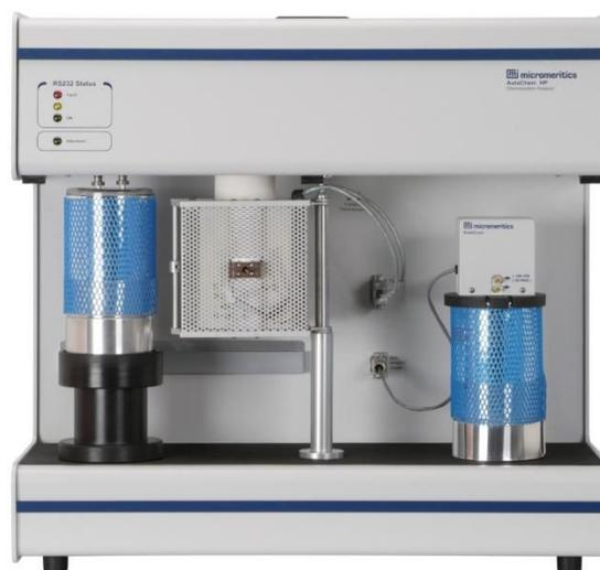
**Figura 2.5.** TPR: Equipo utilizado para la determinación de perfiles de reducción a temperatura programada de muestras en polvo.
