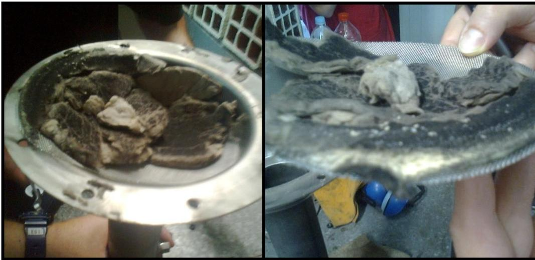
**Figura 7.4.** Fotografías del papel luego del colapso de la malla en el primer ensayo en UTN.
