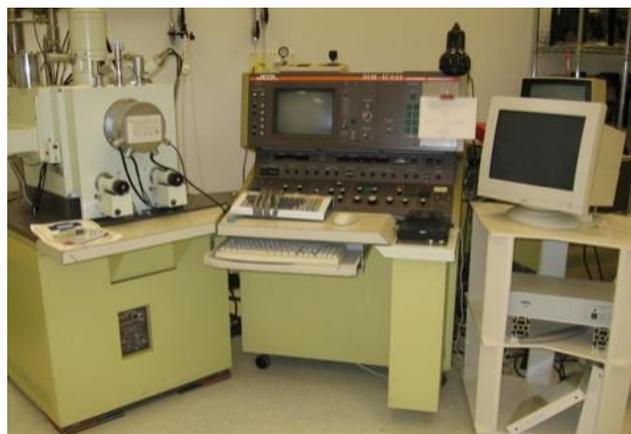
**Figura 2.7.** Equipo utilizado para estudio morfológico y textural de muestras estructuradas.
