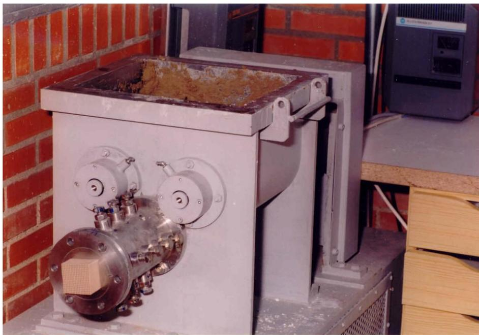
**Figura 3.1.** Fotografía de la máquina extrusora utilizada para la conformación de monolitos (ICP, Madrid, España).
