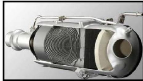
**Figura 1.7.** Esquema del Filtro Anti Partículas HDi FAP de Peugeot.
