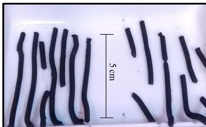
**Figura 4.1.** Fotografía de los pellets obtenidos por el método de extrusión en jeringa.
