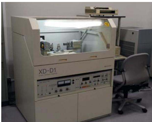
**Figura 2.1.** DRX: Equipo utilizado para la determinación de fases cristalinas de polvos y catalizadores estructurados.
