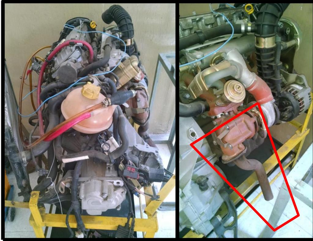
**Figura 2.** Fotografías del motor Fiat diesel 1.7 turbo diesel con la salida del múltiple escape donde se acoplará la carcasa.
