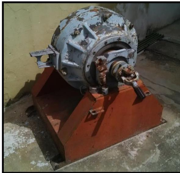
**Figura 5.** Fotografías freno de corrientes parásitas.
