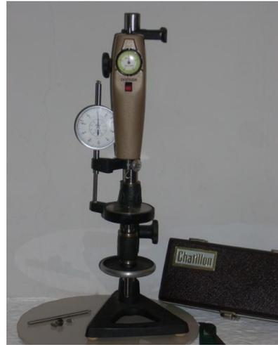
**Figura 2.10.** Equipo utilizado para la determinación de resistencia mecánica de monolitos tipo panal de abeja y pellets.
