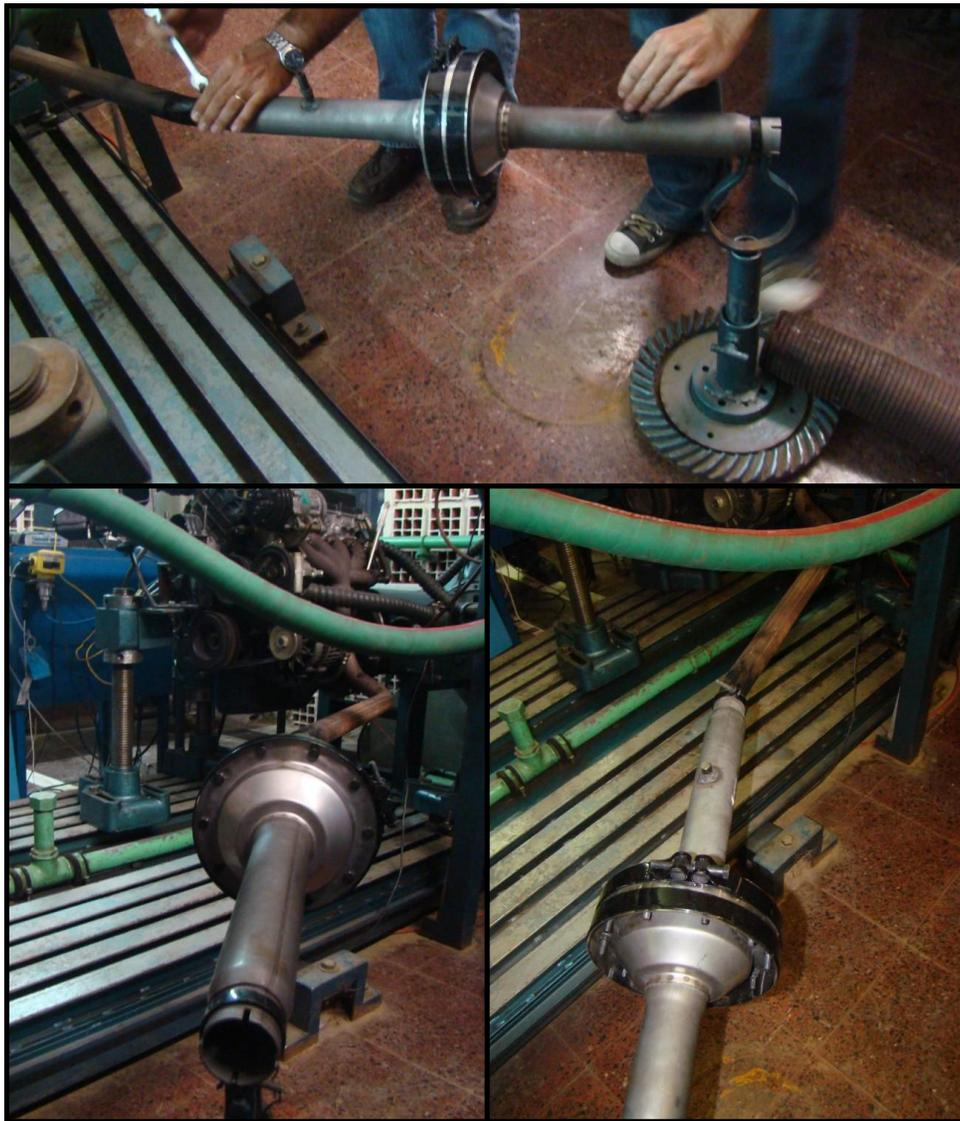
**Figura 7.2.** Fotografías del acople de la carcasa al caño de escape del banco de pruebas de motores (UTN Regional Santa Fe).
