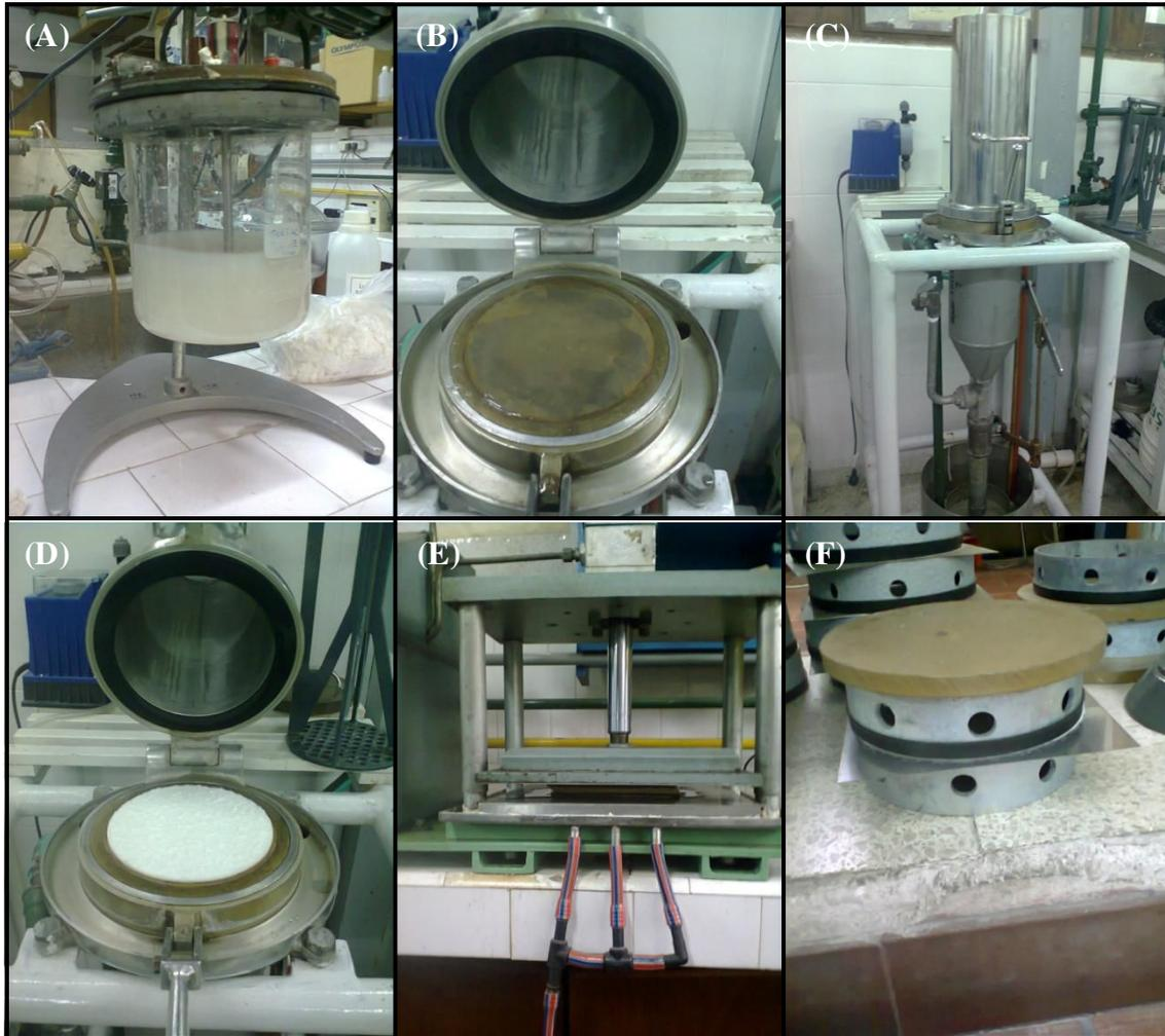
**Figura 5.2.** Fotografías de los equipos utilizados en la fabricación de papeles cerámicos. (A) Mezcladora, (B), (C), (D) formadora, (E) prensa y (F) cámara de secado.
