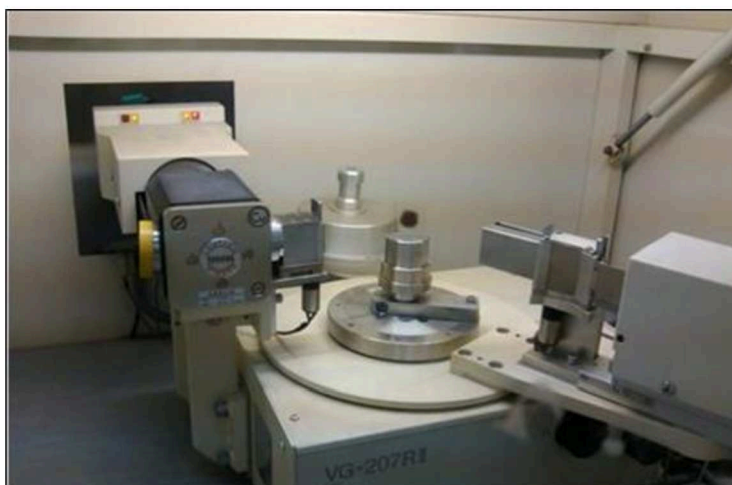
Figura 3.6. Difractómetro Shimadzu XD-D1 utilizado para adquirir los difractogramas de las pulpas.
