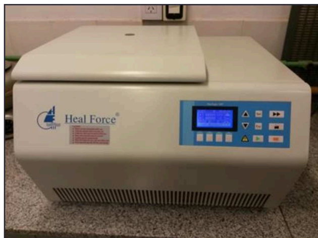
Figura 3.15. Centrífuga Heal Force-Neofuge 18R con sistema de refrigeración.
