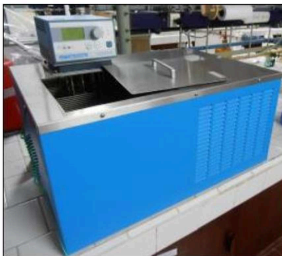
Figura 3.8. Criotermostato Cole-Parmer con baño de etilenglicol 50 % utilizado en los ensayos de solubilidad a temperaturas por debajo de 0 °C.
