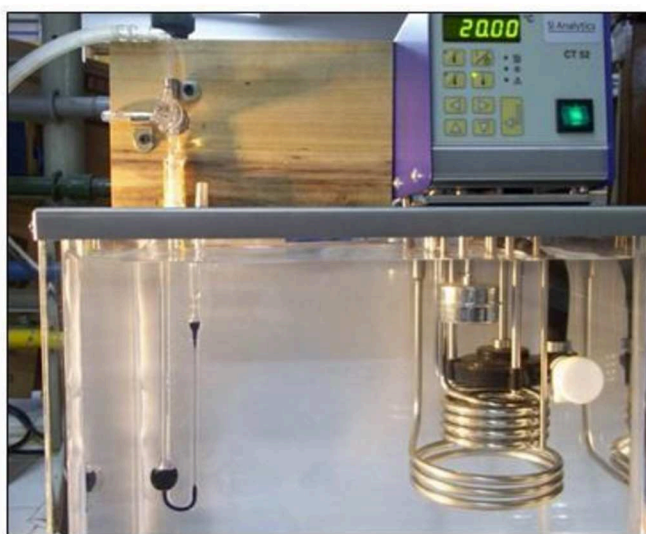
Figura 3.3. Baño termostático y viscosímetro capilar utilizado para determinar [\eta] .
