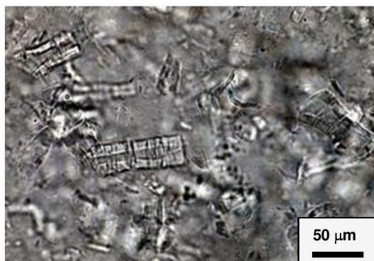
Figura 4.26. Fracción disuelta donde se observa el hinchamiento y los cortes en la pared S1 de las fibras de celulosa de la pulpa SR-C9.
