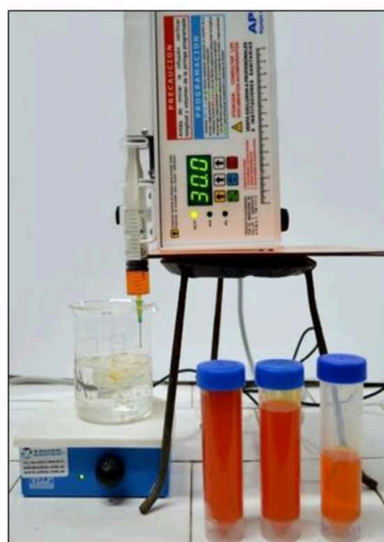
Figura 3.26. Preparación de celulosa esférica con solución de viscosa.
