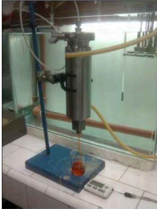
Figura 3.13. Equipo de filtración utilizado para la determinación de K_w .
