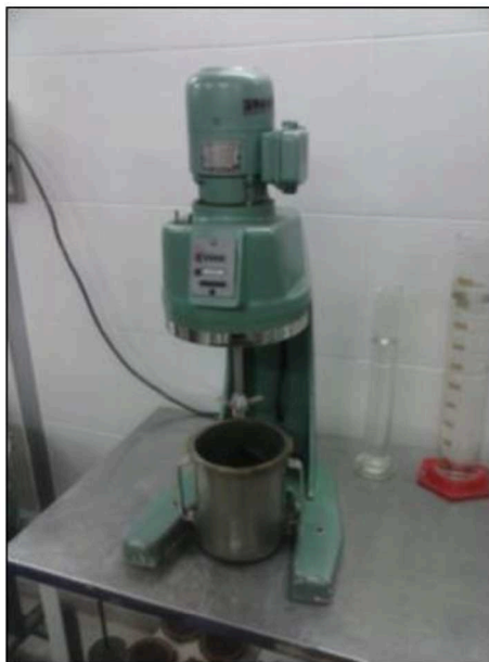
Figura 3.2. Desintegrador estándar British de baja consistencia.
