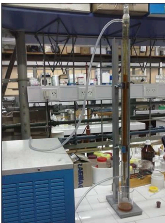
Figura 3.19. Viscosímetro capilar gravitatorio diseñado especialmente para determinar la función reométrica \eta(\dot{\gamma}) .
