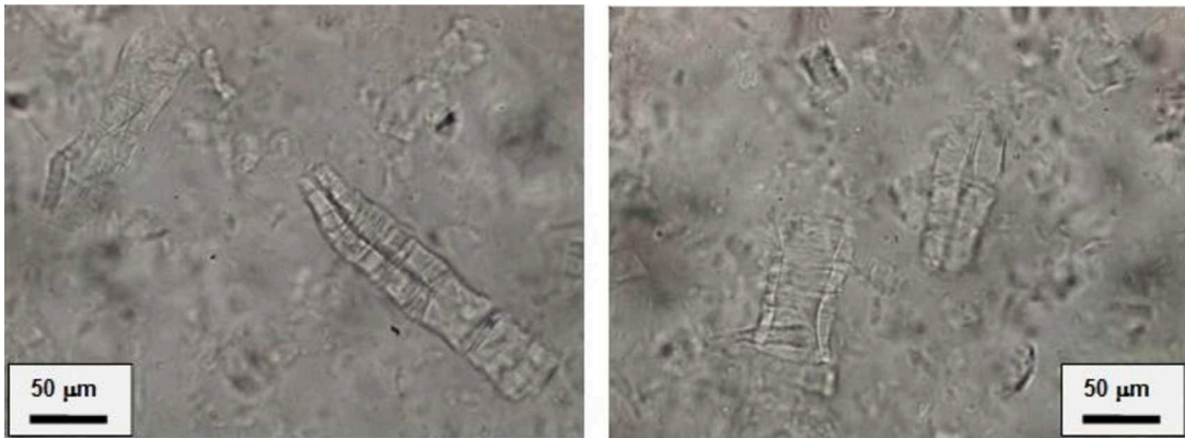
Figura 3.24. Solución de 4,5 % de celulosa en NaOH 7 % / urea 10 % a -7,5 °C (orden 14).
