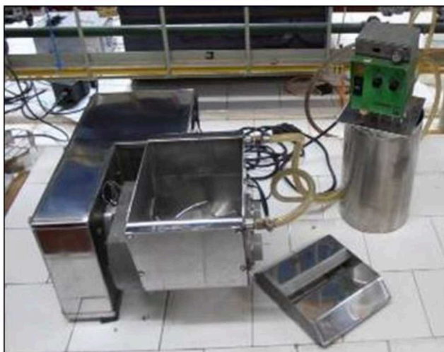
Figura 3.9. Mezclador de acero inoxidable provisto de cabezal termostático.
