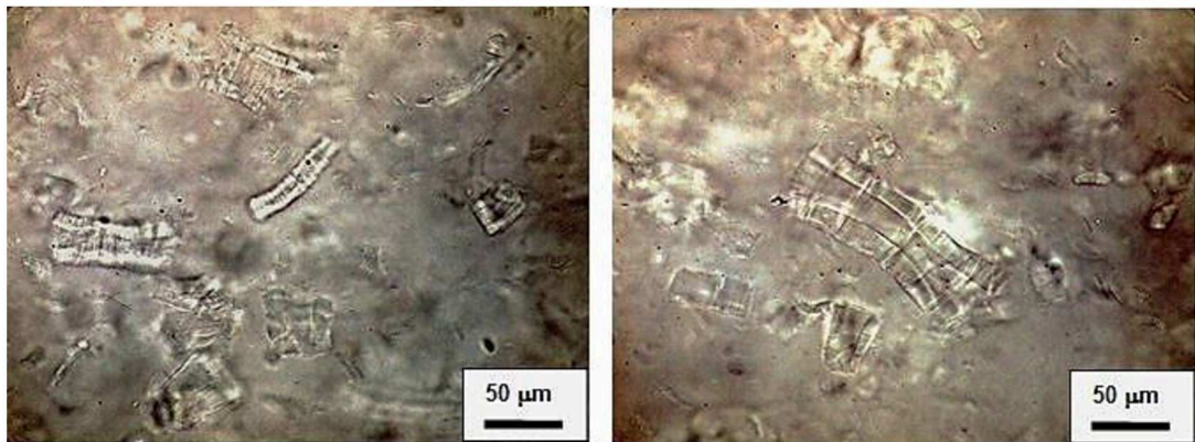
Figura 3.25. Solución de 5 % de celulosa en NaOH 7 % / urea 10 % a -10 °C (orden 5).
