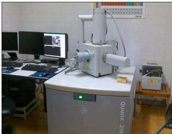
Figura 3.25. Microscopio electrónico FEI Quanta 250.
