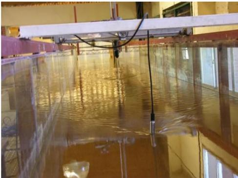
**Figura II.32.-** ADV Vectrino y turbidímetro ubicados en el centro del canal, midiendo ambos a 10 cm respecto del fondo y separados entre sí una distancia aproximada de 2 m.
