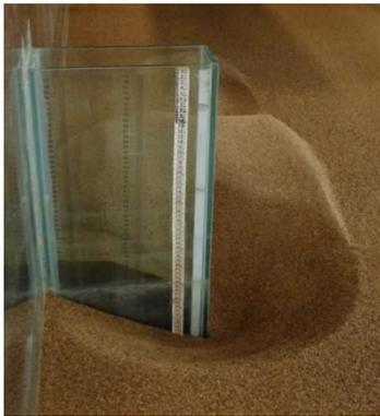
**Figura II.8.-** Reglas adosadas a las paredes del estribo
