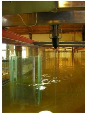
**Figura II.9.-** Medición de profundidades con ADV Vectrino
