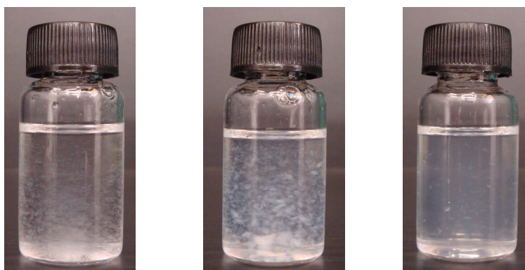
Figura 48. Apariencia visual de polvos resuspendidos en agua desionizada pH 7. AL-OVAn (izquierda), AL-OVAn-GA (centro) y AL-OVAn-PAM (derecha). Concentración 2 g/L.
