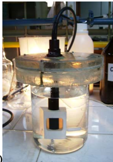
Figura 5.11. a) Esquema del dispositivo utilizado para la determinación de la capilaridad efectiva de láminas de madera y la disposición de la misma durante la determinación. b) Fotografía del dispositivo utilizado.
