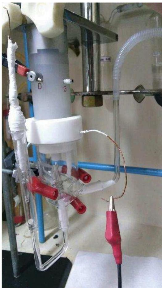
Fig. 2.7. Celda para disco rotante
