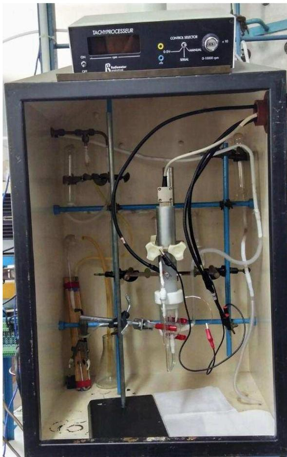
Fig. 2.6. Campana de extracción y tren de purificación para el empleo de CO.
