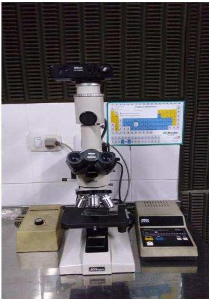
Fig. 2.1. Microscopio óptico metalográfico Nikon modelo Optiphot.
