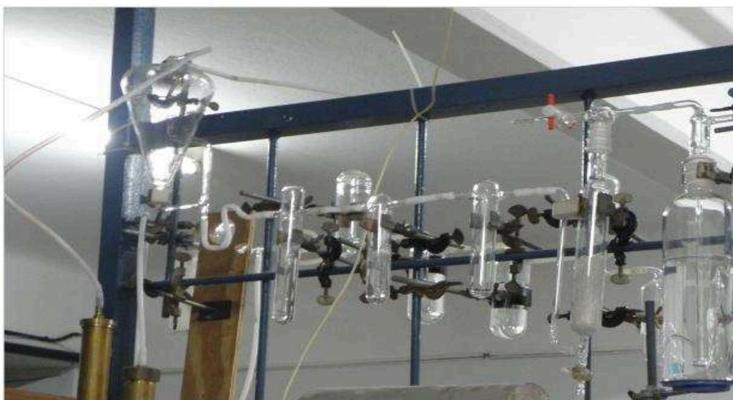
Fig. 2.17. Tren de purificación de gases.
