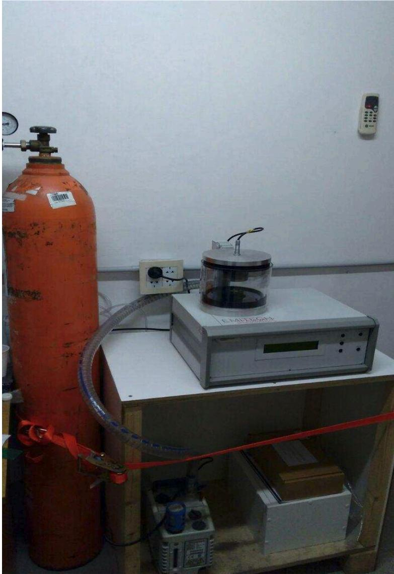
Fig. 2.18. Unidad metalizadora por sputtering Emitech-Quorumtech.
