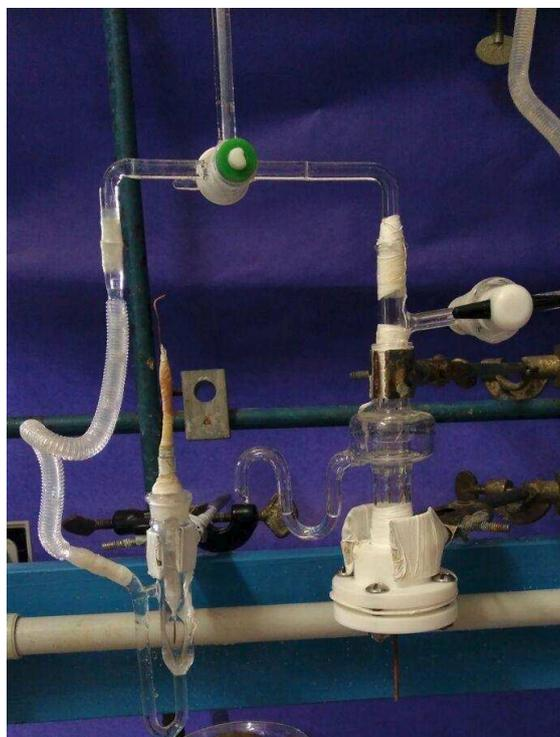
Fig. 2.10: Fotografía de la celda de flujo.
