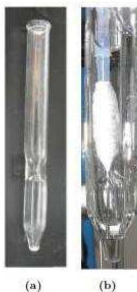
Fig. 2.15. Electrodo de referencia: (a) capilar de vidrio con estrangulaciones, (b) electrodo de burbuja de hidrógeno.
