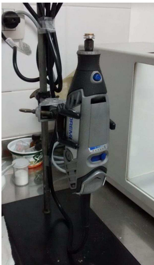
Figura A-6. Montaje de un minitorno para su empleo como spin coater .
