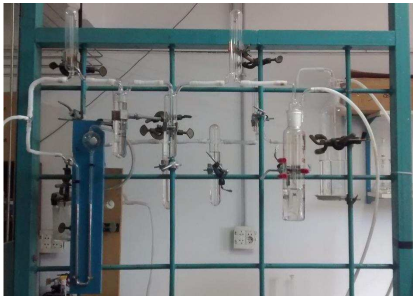
Figura A-4. Tren de purificación de gases.
