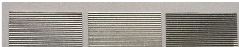
Figura 2. Fotografías del sustrato de aluminio: a) sin tratamiento b), con un tratamiento en HCl por 15 min; c) con un tratamiento en HCl por 30 min.
