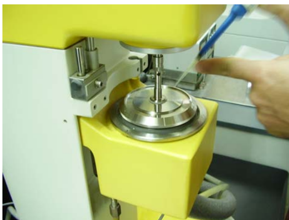
Figura 4.2. Reómetro con tensión controlada Rheostress RS80.
