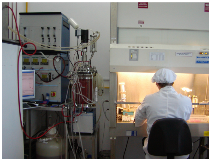
Fig. 5: Vista general del biorreactor con los módulos periféricos, tales como el motor de agitación (gabinete ubicado debajo del vaso de vidrio), la estación de mezclas de gases (gabinete lateral superior) y las unidades de control (gabinete lateral inferior) y con los equipos periféricos, como la cabina de seguridad biológica con flujo laminar de aire estéril, para la manipulación en condiciones de esterilidad.
