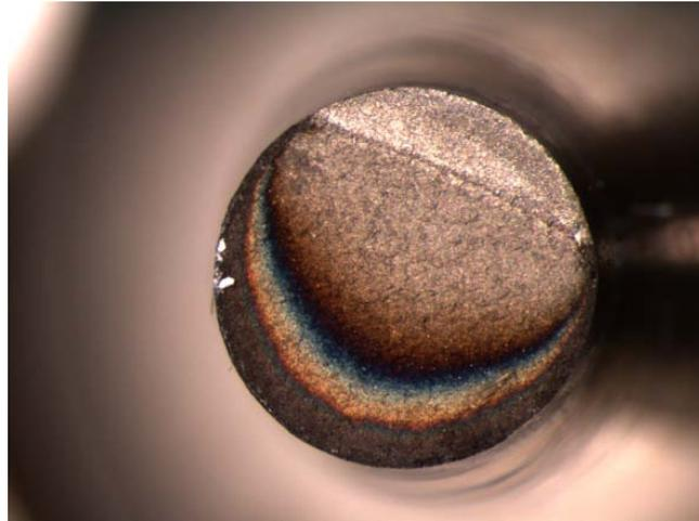
Figura 4.14: Superficie de fractura obtenida con un microscopio óptico en una probeta que falló a 337 MPa y  $1.85 \times 10^5$  ciclos.
