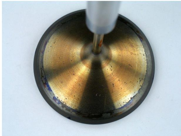
Figura 5.21: Imagen de la válvula luego de haber sido ensayada en la VTR.
