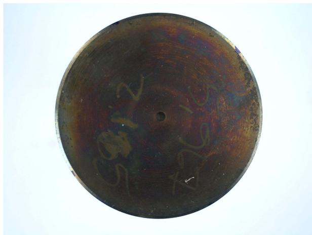
Figura 5.22: Imagen de la cabeza de la válvula luego de haber sido ensayada en la VTR.
