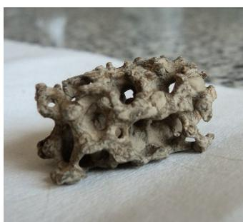
**Figura 2.** Espuma de silicato de aluminio (calcinaada)
