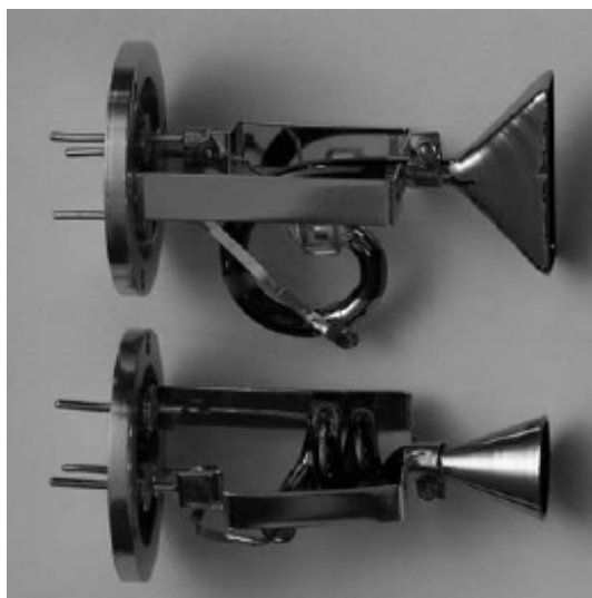
Figura 3.3: Fotografía de dos detectores multiplicadores de electrones modelo Channeltron 4800, con abertura circular (Galileo Electro-Optics Corporation) y rectangular (Burle Industries Inc.).
