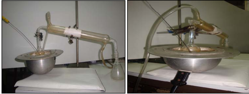
Figura 3.2. Equipo de destilación utilizado para separar el metanol residual.
