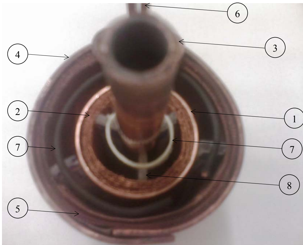
Figura 5.11. Fotografía del dispositivo experimental de configuración cilíndrica con un electrodo tridimensional bipolar. (1) Zona catódica del electrodo bipolar, (2) región anódica del electrodo tridimensional, (3) cátodo terminal, (4) ánodo terminal, (5) mallas de cobre arrolladas al ánodo terminal, (6) alimentador de corriente anódico, (7) aros plásticos, (8) placas delgadas de acrílico.
