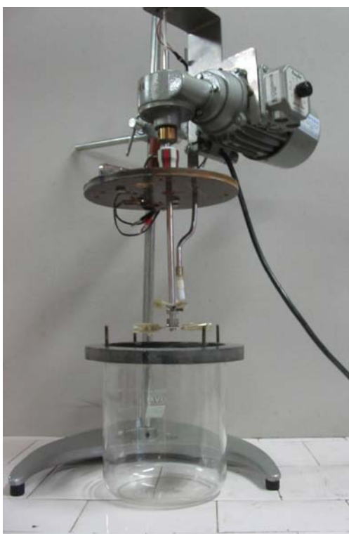
Figura 6.18. Reactor de 3 L utilizado para llevar a cabo el tratamiento con ozono.
