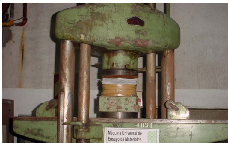
Figura 6.5. Prensado de las hojas de laboratorio en el Dinamómetro Hidráulico Franck de 50 T de capacidad ubicado en la Planta Piloto de la Facultad de Ingeniería Química.
