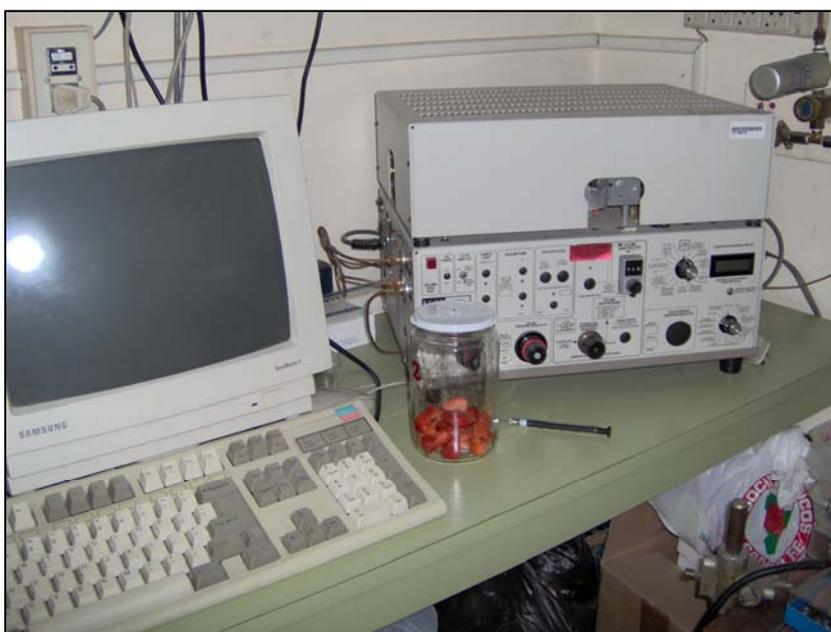
**Figura 2.13** Equipo utilizado para la determinación de la intensidad respiratoria.
