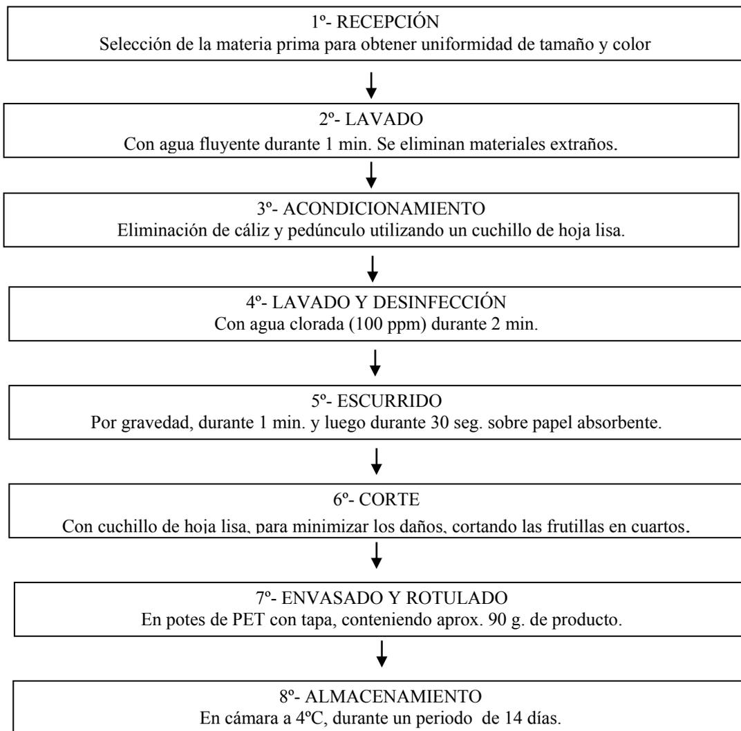
**Figura 2.3 Esquema del procesamiento correspondiente a la primera etapa**
