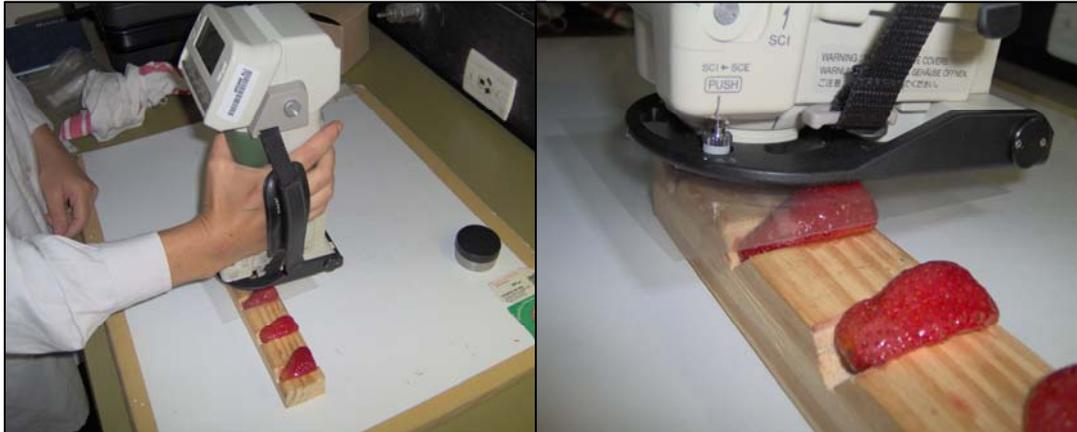
**Figura 2.12 Medición de los parámetros de color sobre frutillas frescas cortadas**
