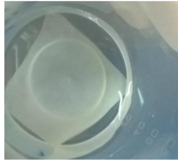
Figura 5.14. Hidrogel tratado con solución de citrato de sodio (7 % p/v) y cargado con diclofenaco sódico, luego de sumergirlo en solución de HCl a pH 2,0 y a 37°C.
