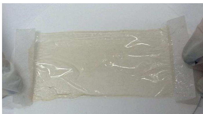
Figura 5.8. Hidrogel entrecruzado con solución de citrato al 7% (p/v), luego de sumergirlo en agua destilada durante 24 h a 23° C.
