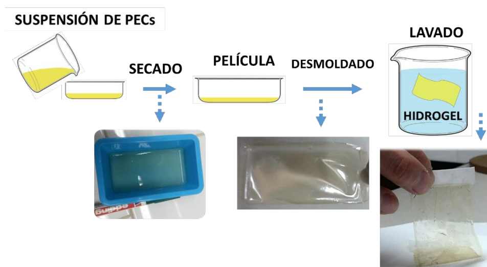
Esquema 5.1. Secuencia para la obtención los hidrogeles de Xil/Q.
