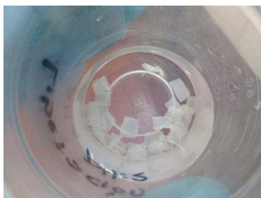
Figura 5.16. Hidrogel tratado y cargado con diclofeanaco sódico en solución de HCl a pH 2,0 y a 37 °C. (Área 0,25 cm 2 ).
