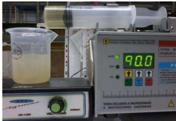
Figura 4.2. Preparación de los complejos de polielectrolitos de Xil/Q a pH 5,0 y fuerza iónica 0,03 N para la obtención de películas.
