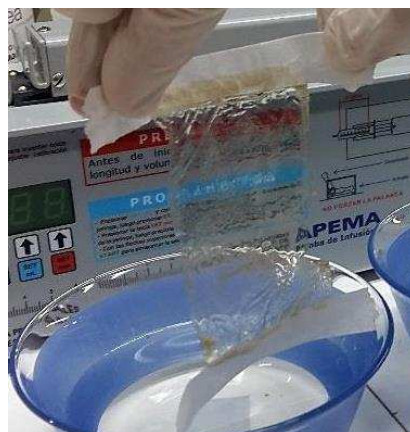
Figura 5.4. Hidrogeles luego del tratamiento con agente de entrecruzamiento iónico.
