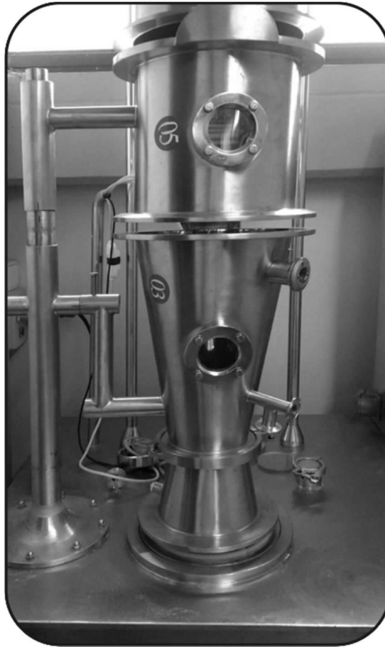
Figura 11. Fotografía del equipo de lecho fluidizado utilizado en esta tesis (modelo DPL1, Rotech, China).
