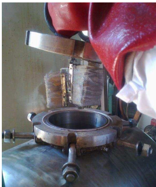
Figura 3.11. Imagen que muestra cómo se introdujeron las cestas con las láminas en el reactor.
