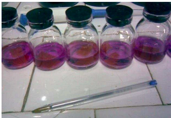
Figura 5.7. Fotografía de los recipientes conteniendo las láminas y la solución luego de que se agregó fenolftaleína.
