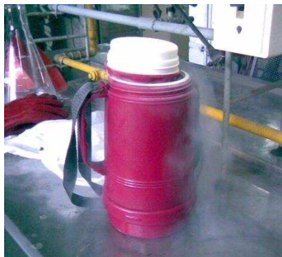
Figura 5.4. Termo conteniendo los cubos siendo sumergidos en nitrógeno líquido.
