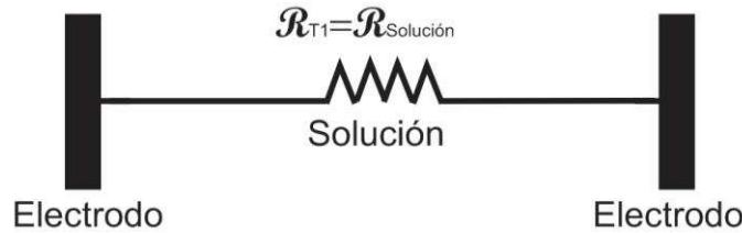
Figura 4.5. Esquema representando el circuito eléctrico para la determinación de la conductividad de la solución (Caso 1).
