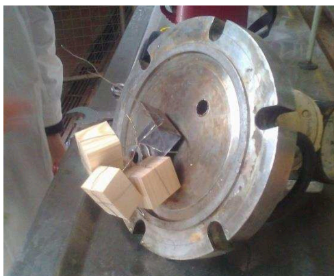
Figura 5.2. Cubos de madera sujetos a la tapa del digestor.
