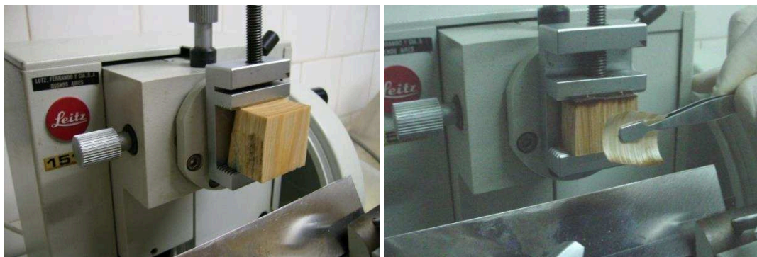
Figura 5.6. Fotografías mostrando cómo se obtuvieron las láminas a partir de los cubos.
