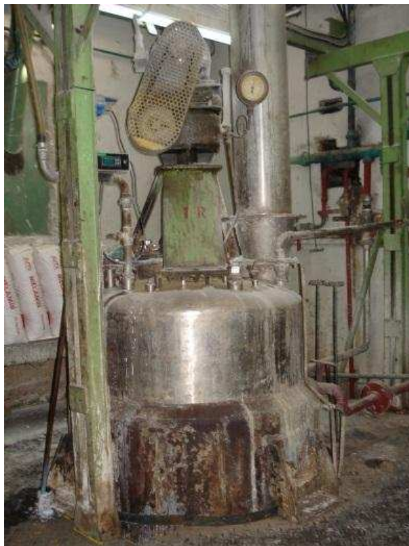
Fig. 1.3. Reactor tipo tanque agitado discontinuo marca LAMPE LUTZ (Argentina) perteneciente a la firma Centro S.A. empleado para la síntesis de la resina base de U-F.
