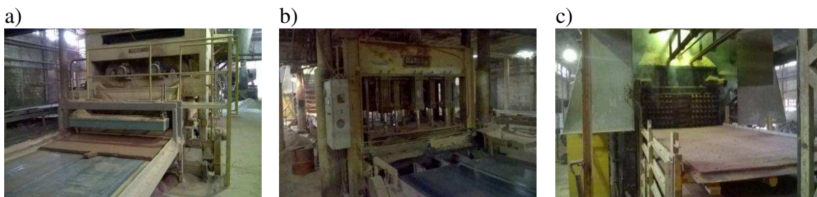
Fig. 1.6. Prensado: a) Formadora de tableros; b) Pre-prensa monoplato; y c) Prensa multiplato.
