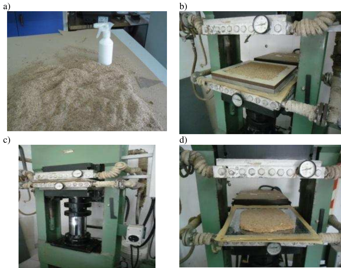
Fig. 5.1. Proceso de obtención de los paneles: a) Encolado, b) Prensado en frío, c) Curado, y d) Desmolde.
