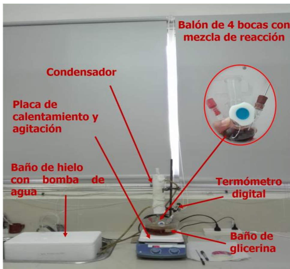
Figura VII-3. Equipo empleado en la reacción de alquilación de guayacol con ciclohexeno
