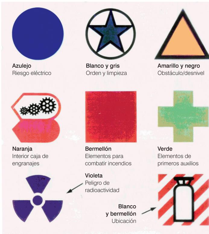
Figura 42. Señalización de zonas y zonas de seguridad (Norma IRAM 10.005).
