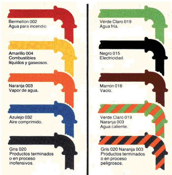
**Figura 43.** Identificación de cañerías (Norma IRAM 2.507)
