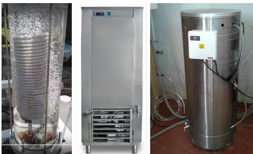
**Figura (3).** Izquierda] Fotografía del sistema de aireación. Equipamiento del sistema de cultivo *outdoor*; Centro] Sistema de enfriamiento comercial.; Derecha] Sistema de calefacción construido por integrantes del GiiB.
