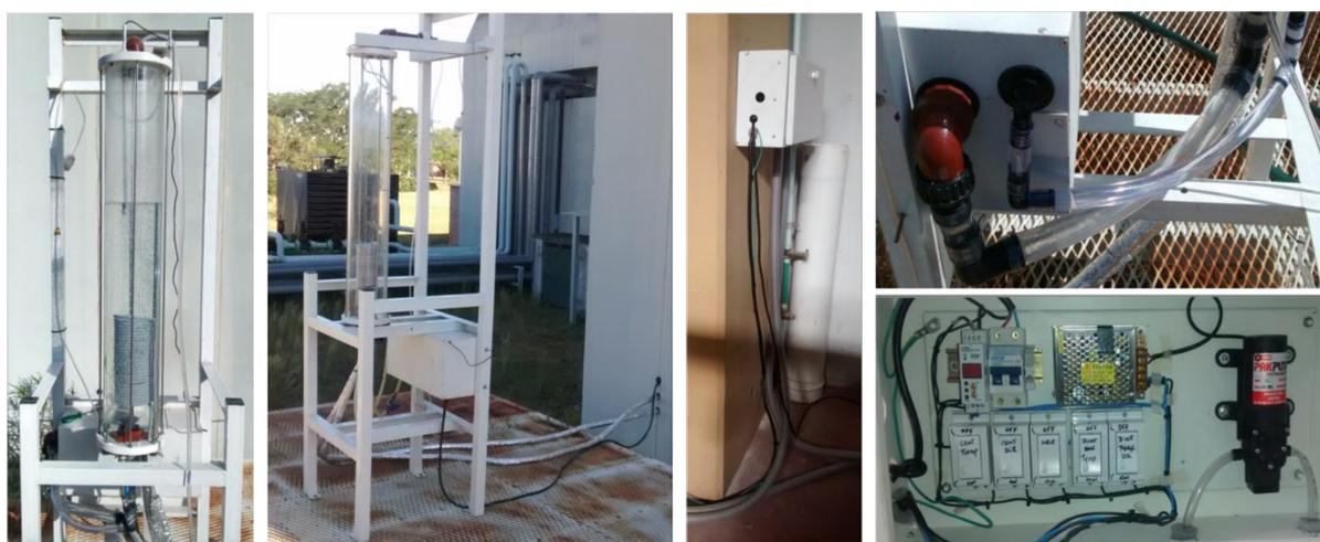
**Figura (2).** Fotografías del reactor *outdoor* columna de burbujeo y de las partes que lo componen.
