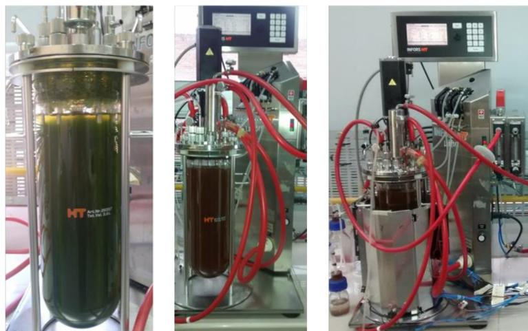
**Figura (4).** Reactor Infors HT Labfors 3. Izquierda] Vaso del reactor. Centro] Plataforma de control. Derecha] Reactor Infors HT con el módulo de iluminación LED construido.
