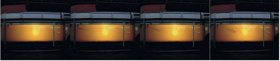
**Figura 10.41.** Ensayo de laboratorio - descarga rápida en bloque (el material cae rápidamente al fondo).
