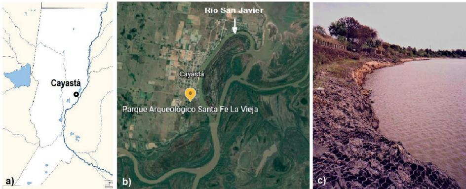
Las sucesivas crecidas del río San Javier han provocado erosiones sobre la margen derecha, que pusieron en riesgo las ruinas allí existentes. En respuesta a esta situación, sobre finales de los años 90, se construyó un sistema de defensa conformado por un muro de contención, seguido de una combinación de piedra suelta, gaviones y colchonetas (Figura 9.12.c). Esta obra no brindó los resultados esperados, siendo necesaria su reparación y reconstrucción en varias oportunidades.
