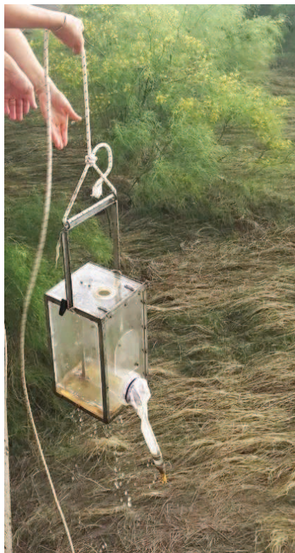
Figura 8 Muestreo de la comunidad zooplanctónica mediante una trampa tipo Schindler-Patalas (20 L) con una red de 40 \mu\text{m}
