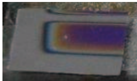
Figura 5.28. Muestra de silicio cristalino, de 2,3 cm de ancho por 1,3 cm de alto, con película delgada de SiO 2 , de 15 mm de ancho por 6 mm de alto.
