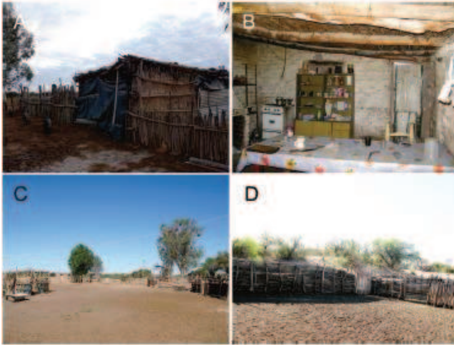
Figura 6: Casas rurales y estructuras peridomiciliarias típicas en los distritos de La Asunción y San José, Mendoza, Argentina, en donde se han encontrado Triatoma infestans . A) Domicilio hecho de barro y caña. B) Interior de un domicilio hecho con techo de caña. C) Corrales de cabras y gallineros. D) Corral de cabras típico con paredes de ramas apiladas. (Imagen adaptada de Carbajal-de-la-Fuente et al., 2017 [27]).
