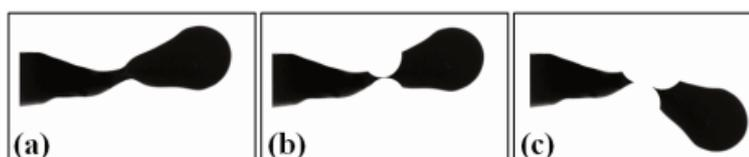
**Figura 2.12:** Esquema representativo del proceso de formación de cuello y decapitación de una punta por bombardeo iónico. (a) Etapa de formación del cuello, (b) etapa final antes de la decapitación, (c) decapitación.
