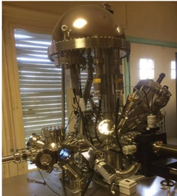
**Figura 2.23:** Espectrómetro SPECS PHOIBOS utilizado. Laboratorio de División Colisiones Atómicas del Centro atómico Bariloche.
