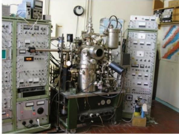
**Figura 2.22:** Espectrómetro VG utilizado. Laboratorio de División Colisiones Atómicas del Centro atómico Bariloche.
