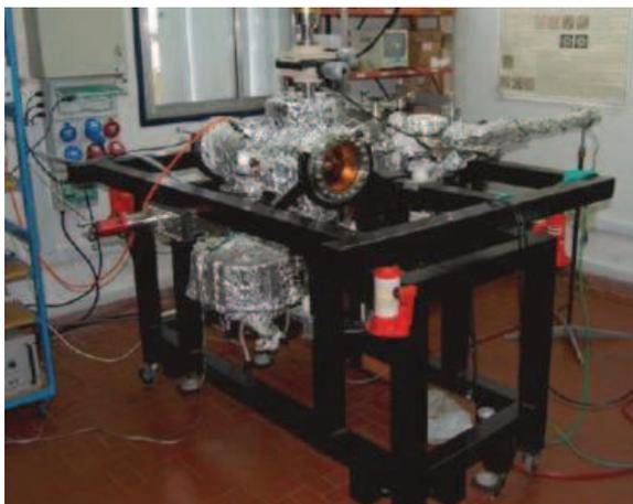
**Figura 2.7:** Fotografía del sistema experimental "STM-UHV" instalado en el Laboratorio de Física de Superficie e Interface del IFIS Litoral, Santa Fe, Argentina.
