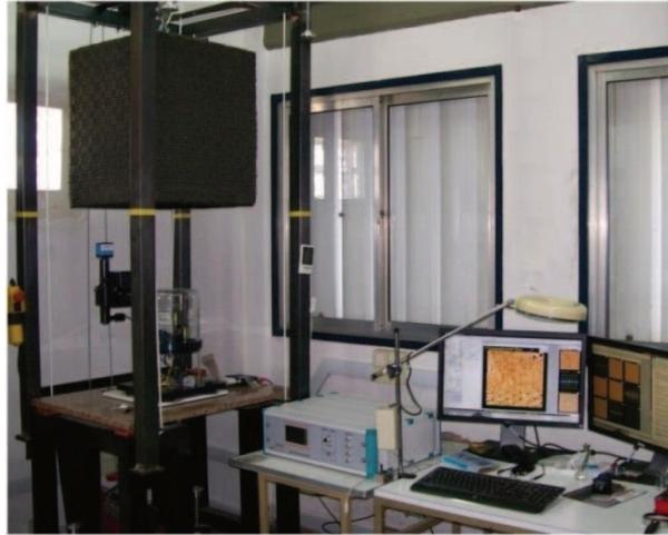
**Figura 2.14:** Fotografía del equipo SPM perteneciente al LASUI (IFIS-Litoral), a la izquierda se observa el SPM sobre la mesada de mármol sostenido por el sistema anti-vibratorio. A la derecha, la electrónica que maneja el equipo denominado módulo Dulcinea de Nanotec Electrónica SL.
