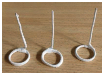
Figura 2.14. Imagen de los soportes armados para sostener los monolitos en el autoclave.
