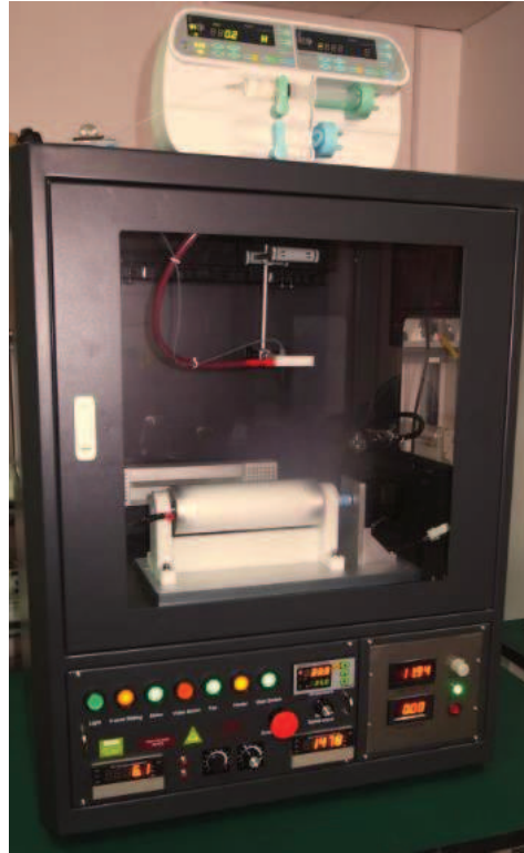
Figura 2.9. Fotografía del equipo de electrohilado Tong Li Tech TL-01.
