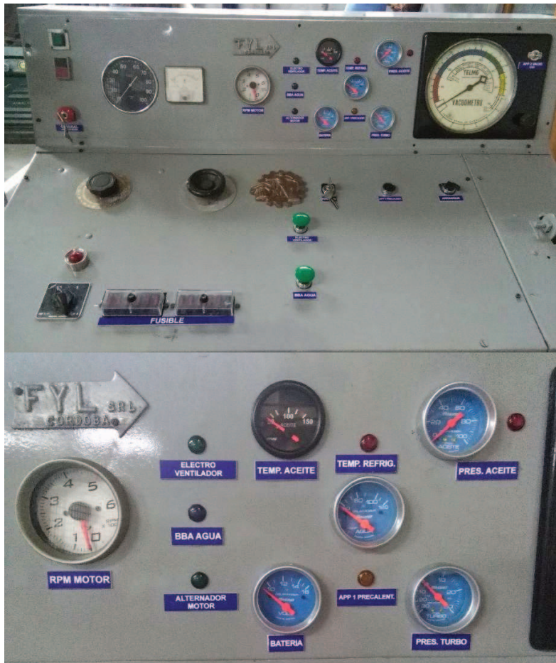
Figura 1: Tablero de control para monitorear la variables, del motor del banco de pruebas
