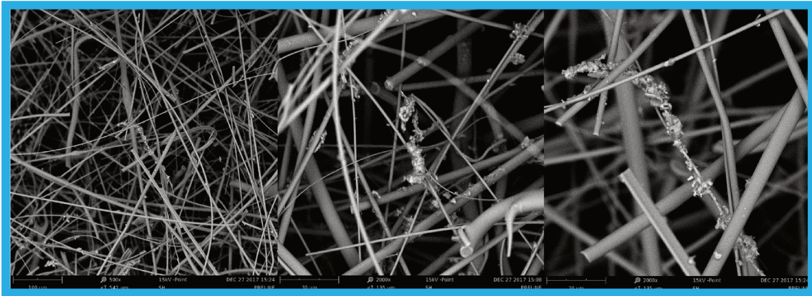
Figura 30: Micrografías SEM de papeles cerámicos con ulexita natural, calcinado a 700°C. Diferentes magnificaciones
