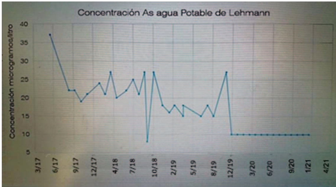
Figura 31. Lehmann: Concentración de As en agua potable ( \mu\text{g/L} ) - Registro de mediciones desde marzo/2017 a septiembre/2020 (foto proporcionada por el Ing. Eduardo Alasia).
