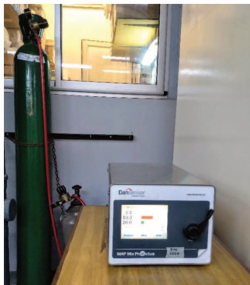
Figura 2.8 Mezcladora de gases utilizada para obtener las distintas composiciones gaseosas
