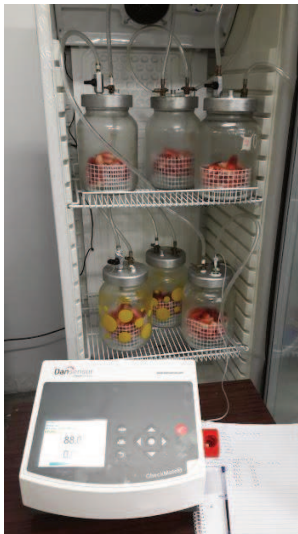
Figura 2.9 Muestras de frutillas mínimamente procesadas almacenadas en recipientes con diferentes atmósferas a 5°C y el analizador de gases para medir la composición
