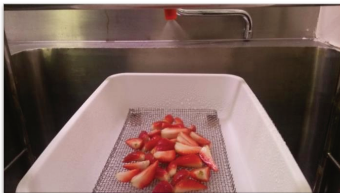
Figura 2.4 Sistema de lavado-desinfección por aspersion para frutillas frescas cortadas
