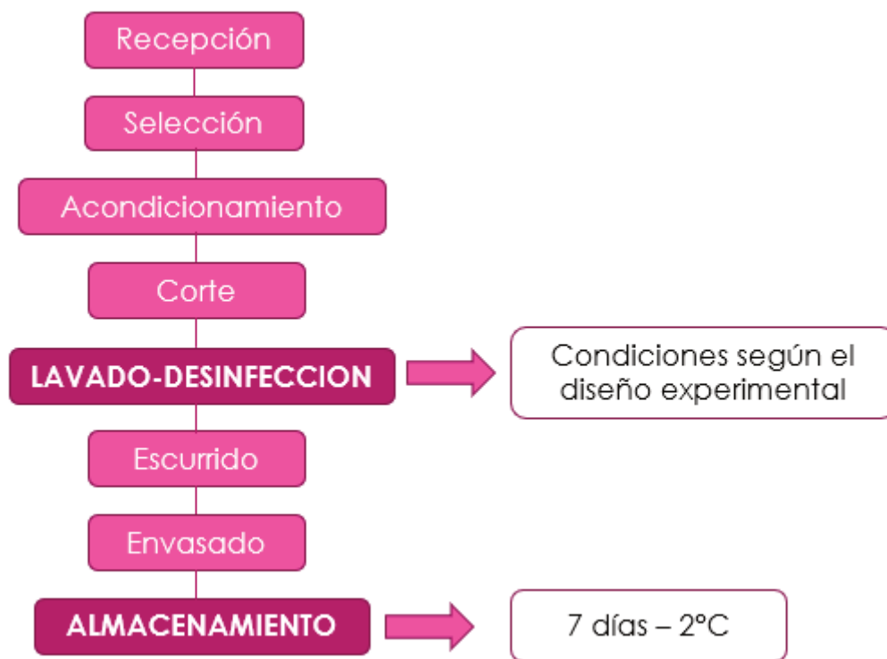
Figura 2.2 Diagrama de procesamiento seguido para obtener frutillas frescas cortadas
