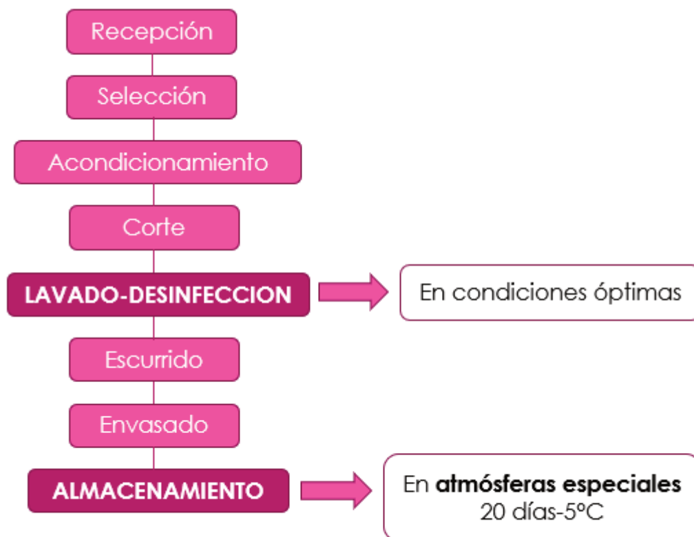
Figura 2.6 Diagrama de procesamiento para estudiar el almacenamiento de las frutillas frescas cortadas en atmósferas especiales
