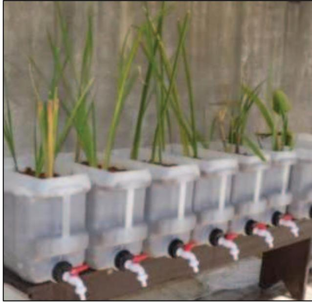
Fig. 1.1. Reactores plásticos de 20 L de capacidad utilizados donde se observan algunas de las especies estudiadas.
