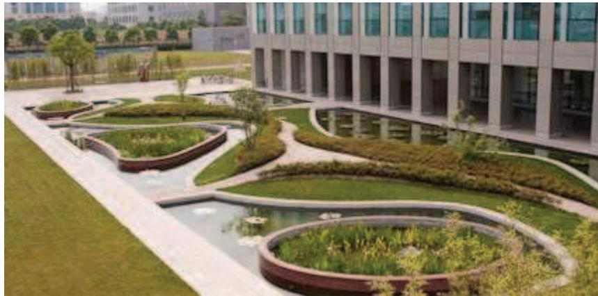
Fig. 3.6. Ejemplos de humedales jardines para el tratamiento de efluente domestico.
