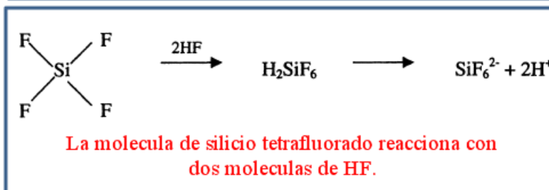
Figura 1.5 Proceso de disolución de silicio durante la formación de silicio poroso propuesto por Lehman y Gösselle.
