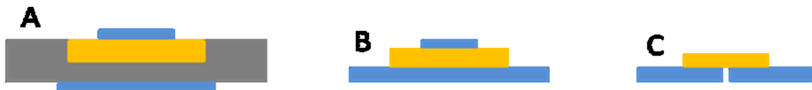
Figura 2.10 Esquema de las tres configuraciones de los dispositivos usados durante esta tesis. El color azul representa los contactos metálicos, el amarillo representa el silicio poroso y el gris el silicio cristalino. A. M/c-Si/SP/M. B. M/SP/M En esta configuración también se reemplazó el contacto posterior por SnO 2 formando estructuras SnO 2 /SP/M). C. M/SP/M.
