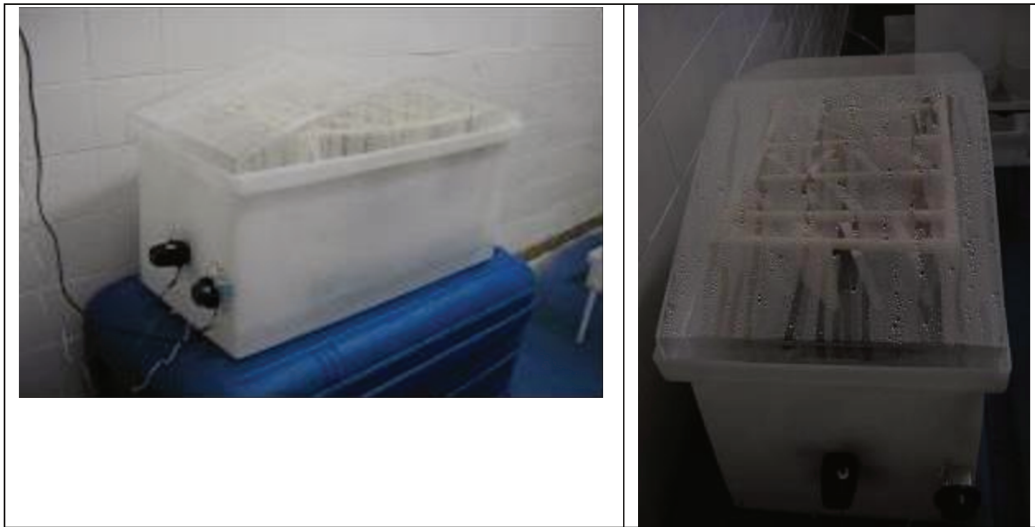
Figura 43. Cámara tropical construida para realizar los ensayos de evaluación antifúngica.
