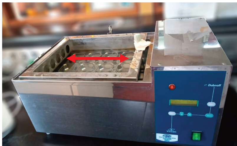
Figura A.10.1. Baño térmico usado para generar las condiciones de liberación. La flecha roja indica la dirección de desplazamiento de la agitación.
