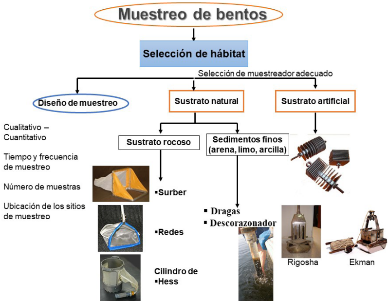
Figura 4 · Diseño de para la recolección de muestras de bentos.
