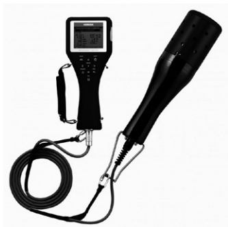
Figura 2 · Ejemplo de sonda multiparamétrica que puede medir conductividad, temperatura, pH, sólidos suspendidos totales.
