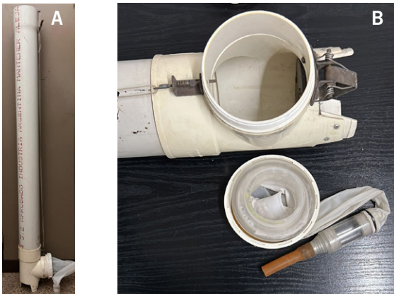
Figura 8 · Muestreador tubular (A), detalle de su estructura (B)
