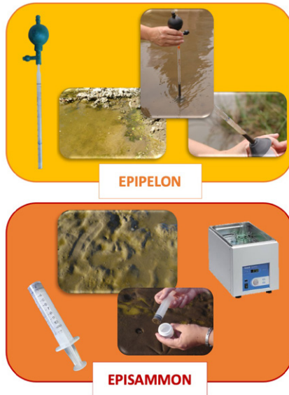
Figura 2 · Muestreadores utilizados para extraer la muestra en sustratos limo–arcillosos ( epipelon ) y arenosos ( episammon ).
