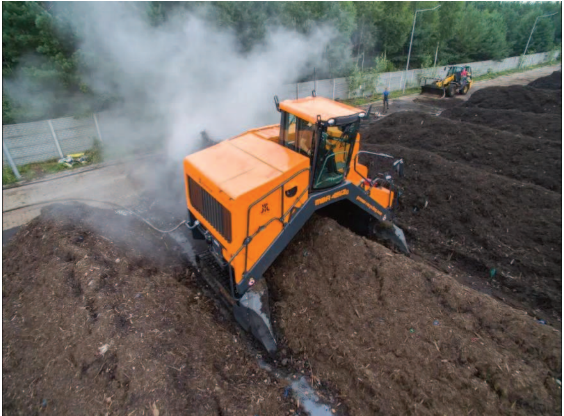
Figura 7.2: Removedor de compost autopropulsado, industria nacional. Fuente: DEISA S.A.
