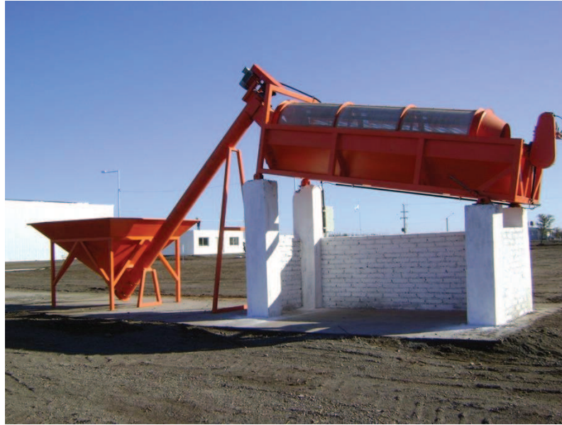
Figura 7.3: Zaranda rotatoria para el cribado del material maduro. Fuente: DEISA S.A.
