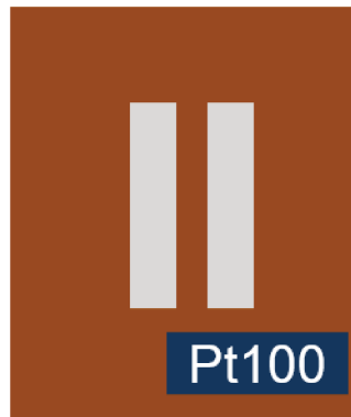
Figura 2.2.6. Vista frontal de la película semiconductor depositada sobre vidrio, con los contactos paralelos y el termómetro de resistencia de platino.
