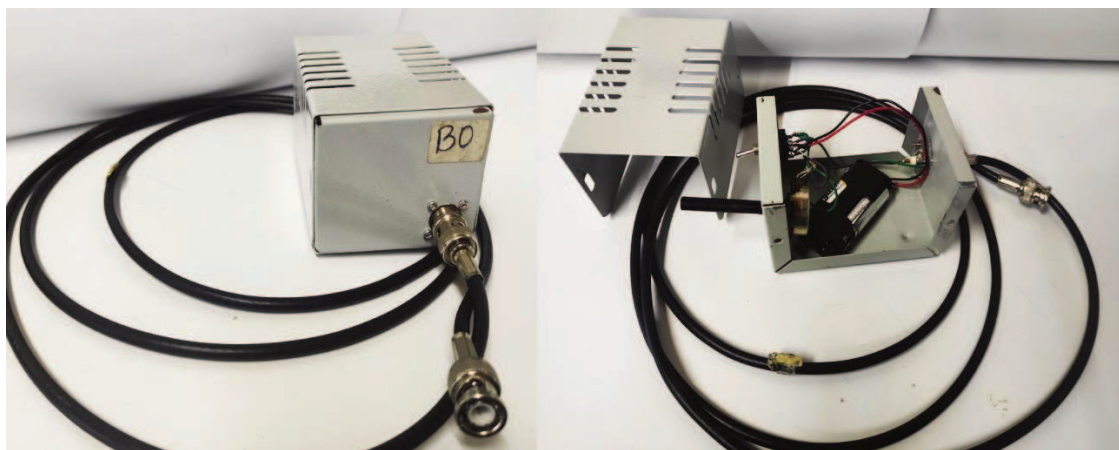
Figura 4.2.4. Fuente de tensión fabricada para realizar mediciones de eficiencia cuántica externa con tensión aplicada.
