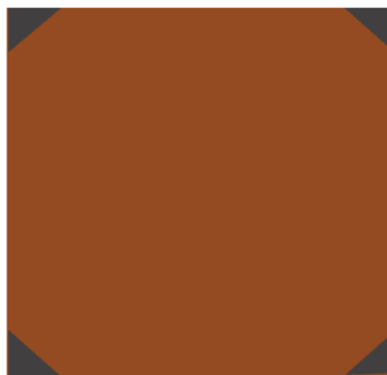
Figura 2.2.3. Esquema de una muestra para medición de resistencia y efecto Hall usando el método de van der Pauw. Se aprecian los contactos metálicos (plata), en los cuatro vértices de la muestra.
