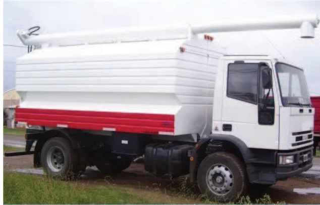
Figura 17: Imagen ilustrativa de camión tolva autodescargable. Fuente: propia.
