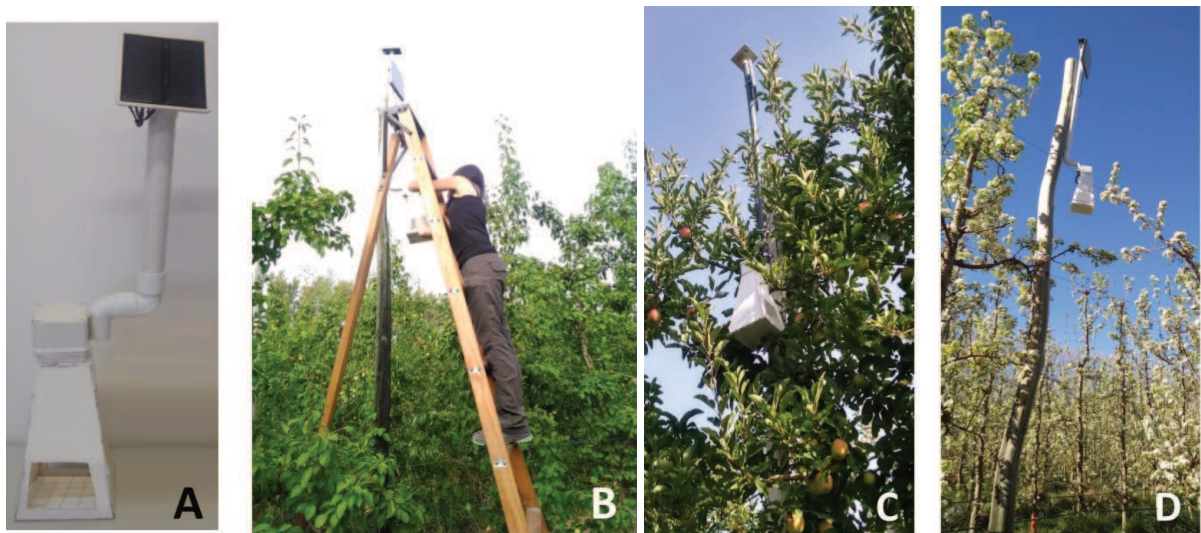
Figura 61. A) Trampa electrónica Prototipo 5. B) Cambio de piso adhesivo de trampa electrónica instalada en árbol de manzana. C) Trampa electrónica instalada en Chacra 1. D) Trampa electrónica instalada en Chacra 2 (Fuente: elaboración propia)
