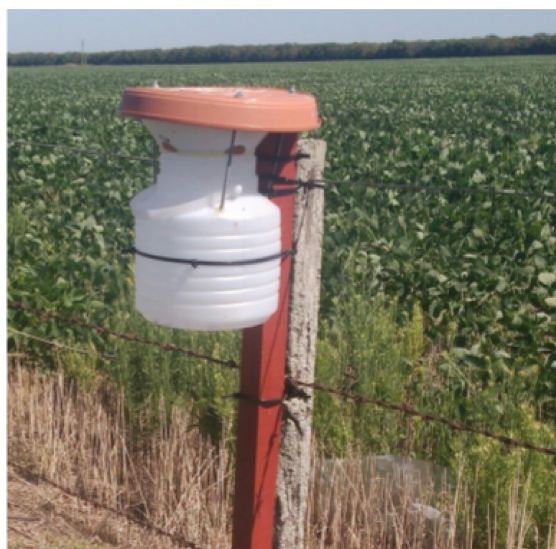
Figura 42. Trampa Prototipo 1 instalada en campos de soja (Lote 1) (Fuente: elaboración propia).
