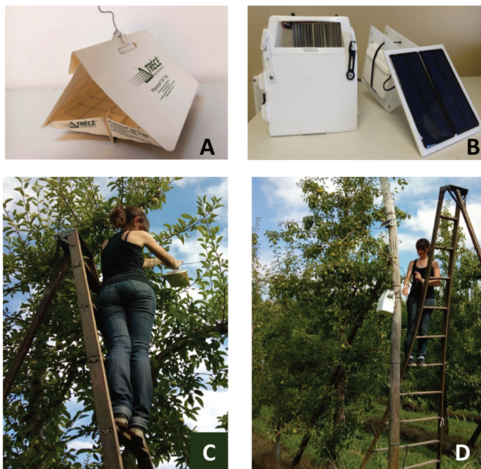
Figura 58. A) Trampa Delta. B) Trampa electrónica Prototipo 4. C) Instalación de trampa Delta en árbol de manzana. D) Instalación de trampa electrónica en árbol de manzana (Fuente: elaboración propia)
