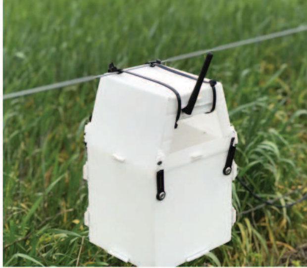
Figura 43. Trampa Prototipo 2 instalada en campo de soja (Lote 1) (Fuente: elaboración propia).
