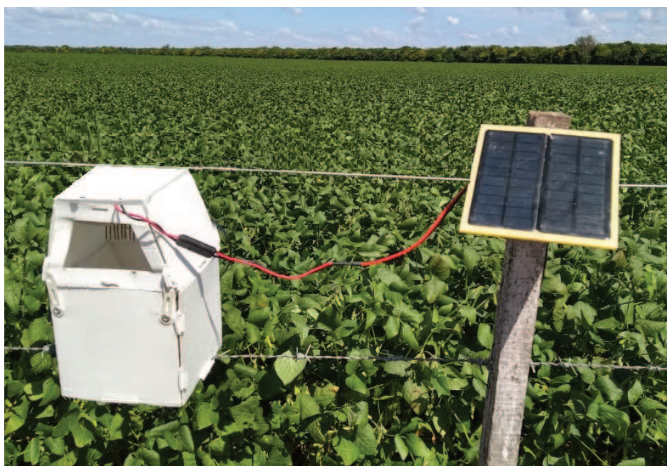
Figura 45. Trampa Prototipo 4 instalada en campo de soja (Lote 2) (Fuente: elaboración propia)
