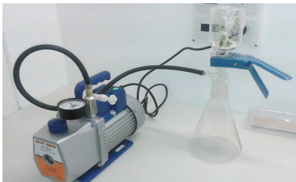
Figura 33. Sistema de recolección de volátiles generados por machos de Nezara viridula (Fuente: elaboración propia).
