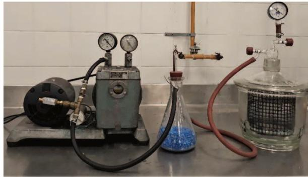
**Figura 3.2.**Equipo de impregnación por vacío
