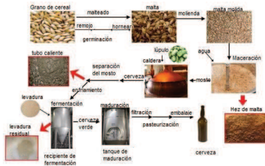
Figura I.3 Proceso de elaboración de Cerveza y obtención de Hez de malta. Adaptado de Rachwał y col., (2020).
