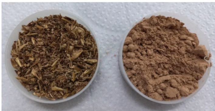
Figura IV.4 Fotografía de la hez de malta seca (izquierda) y del concentrado proteico de hez de malta (derecha).
