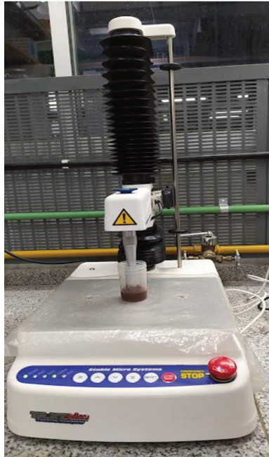
Figura III.2 Texturometro A.XT.plus – Stable Micro Systems utilizado para analizar el perfil de textura de los geles.
