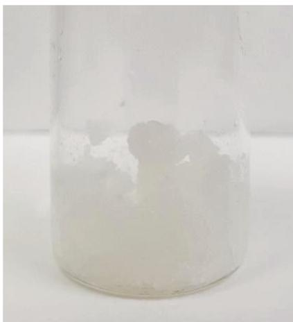
Fig. 2.5: Fotografía correspondiente a LI [bmim]Br purificado en el laboratorio.
