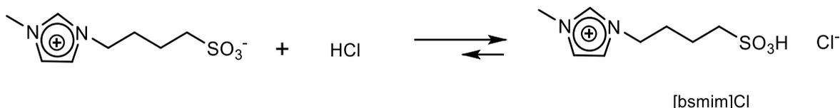
Fig. 3.12: Esquema de reacción de síntesis del TSIL [bsmim]Cl.
