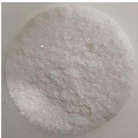
Fig. 6.3: Fotografía del TSIL [bsmim]HSO<sub>4</sub> soportado en sílice.
